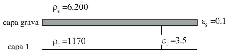
El dispositivo utilizado para conseguir una buena resistencia de puesta a tierra está formado por una malla de conductor de  $50 \text{ mm}^2$  de sección, es decir, un diámetro  $d_1 = 8 \text{ mm}$ , y cullas dimensiones son  $30 \text{ m}$  de ancho y  $20 \text{ m}$  de largo. Dicha malla estará enterrada a  $h = 1 \text{ m}$  de profundidad.
